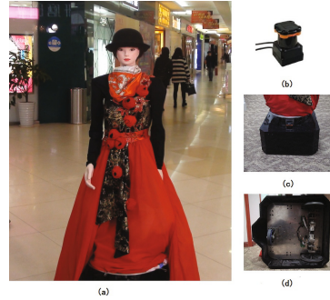
Fig. 2. (a) KeJia robot (b) laser scanner (c) base (d) differential wheels
